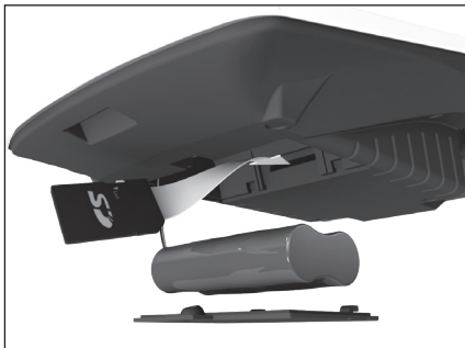
Obrázok 2.8 – Zavedenie SD karty do pokladnice
