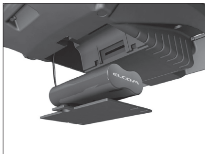
Obrázok 2.8 – Zavedenie SD karty do pokladnice
