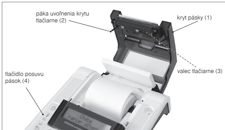
Obrázok 2.6 – Zavedenie papierovej termo pásky do tlačiarne pokladnice
